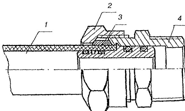
1 - металлополимерная труба; 2 - обжимная гайка;
