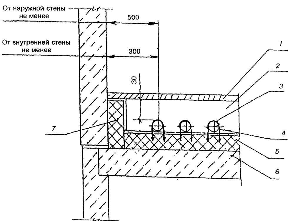
1 - настил пола; 2 - слой бетона; 3 - труба нагревательного элемента; 4 - скоба якорная; 5 - тепло- и гидроизоляция; 6 - плита перекрытия; 7 - боковая теплоизоляция
