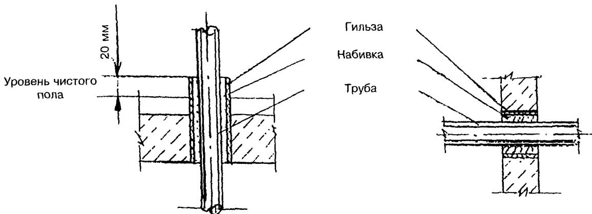
Рисунок 15. Установка гильзы для прокладки труб
