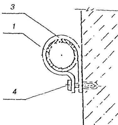
1 - труба; 2 - фиксатор; 3 - хомут; 4 - шуруп (дюбель)
