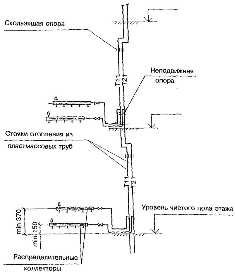
Рисунок 8. Вариант подсоединения распределительных коллекторов к стоякам из металлокомплимерных труб
