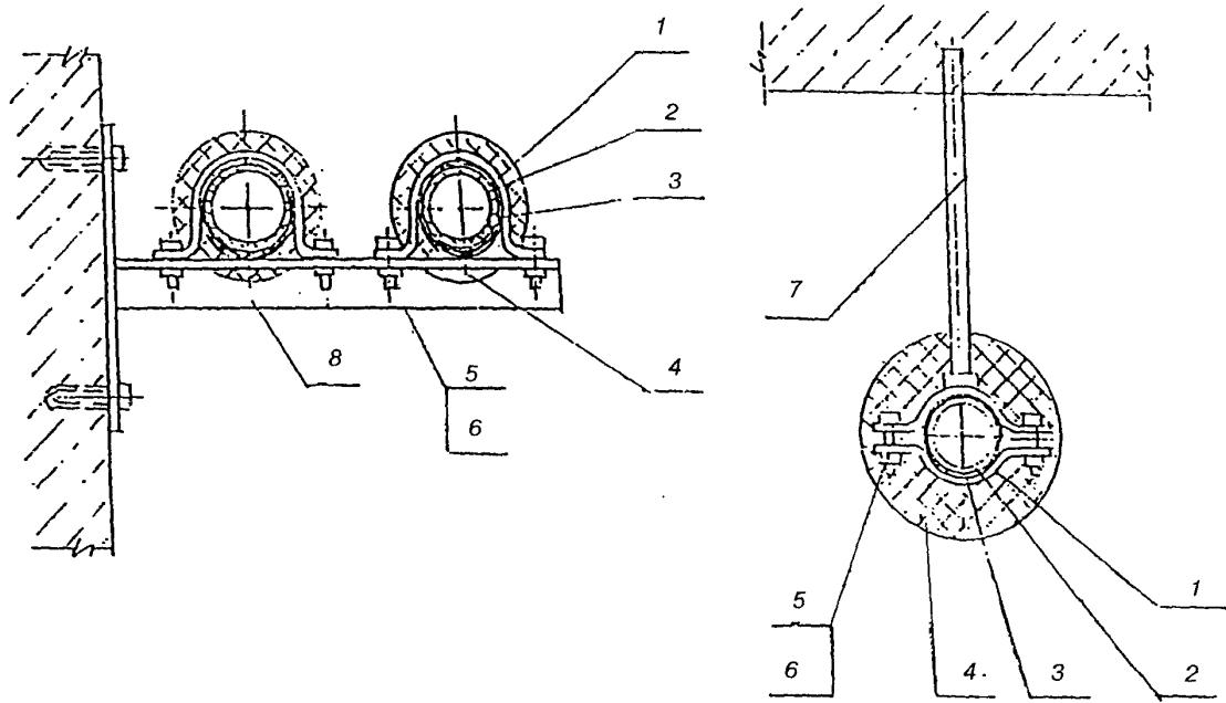
1 - хомут; 2 - труба; 3 - мягкая прокладка; 4 - теплоизоляция;
