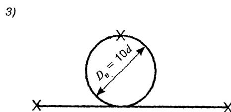
1 - П-образный; 2 - Г-образный; 3 - петлеобразный; а - положение трубы при максимальной температуре; в - то же, при минимальной;  $L_k$  - вылет компенсатора; Х - неподвижная опора; = - скользящая опора
