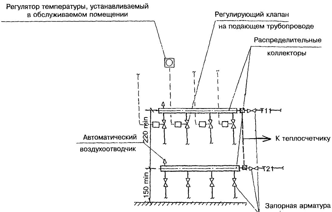
Рисунок 7. Распределительный коллектор системы отопления
